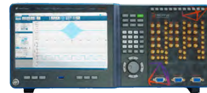
任意波形発生器 量子ビットの制御 に使用
